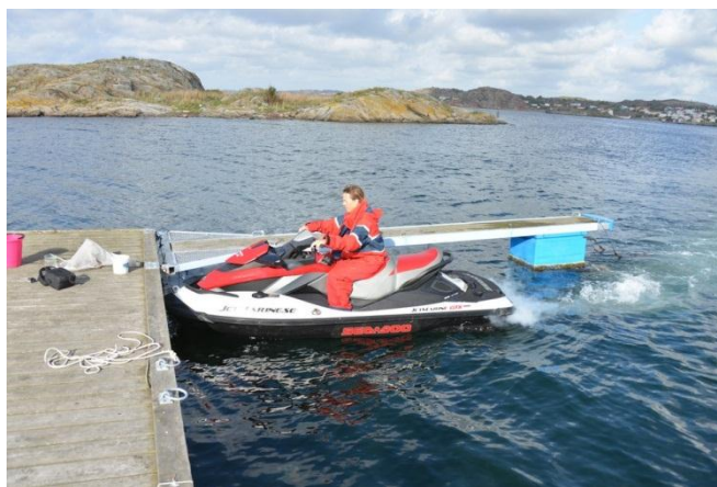
Figur 4 Testuppställning med körande vattenskoter. Prover togs med planktonhåv i utvattnet efter vattenskotern vid olika varvtal.
